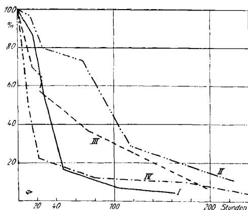
Abb. 4. 5% Thymol in: I kalt geblasenem Leinöl, II heiß geblasenem Leinöl, III Leinöl-Standöl, IV Holzöl-Standöl.
